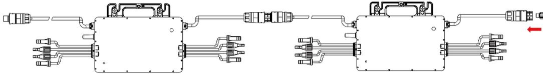
**Schritt 3 - Schließen Sie das AC-Endkabel an.**
