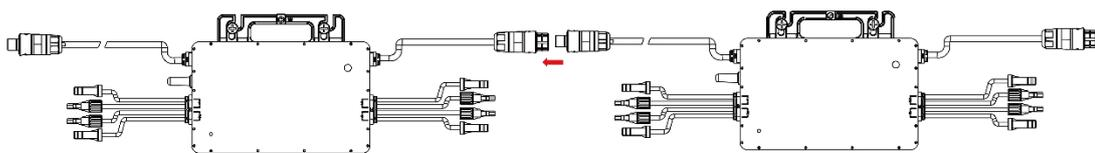
\* Anmerkung: Die Länge des AC-Kabels am Mikrowechselrichter beträgt etwa 2,06m. Wenn der Abstand zwischen zwei Mikrowechselrichtern mehr als 2m beträgt, so verwenden Sie bitte ein AC-Verlängerungskabel zwischen den beiden Mikrowechselrichtern (wie in der Abbildung unten dargestellt).
