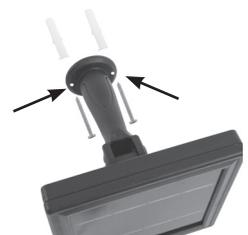
Verwenden Sie für die Befestigung der Montageplatte an der Wand abhängig vom Untergrund (Stein, Beton, Holz, Isolierschaumplatten etc.) geeignetes Montagematerial. Die beiliegenden Schrauben/Dübel sind nicht für alle Untergründe passend!
