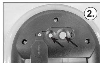
6. Montieren Sie nun die Leuchte auf weichem Untergrund mit Hilfe des Erdspießes. Auf Beton oder Pflaster kann die Leuchte mit den beiliegenden M6 Spreizankern montiert werden. Bohren Sie dazu die Löcher mit 8 mm Durchmesser, stecken Sie die Anker in das Loch und schrauben Sie die Leuchte fest. Die Anker verkeilen sich dann im Beton oder Pflaster. Zum Abdecken der Schrauben können die beiliegenden Kappen verwendet werden.
