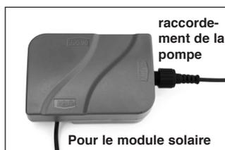
5. Déroulez le câble au niveau du boîtier d'accumulateur et insérez la fiche dans la prise du module solaire. Vissez l'écrou à chapeau.
