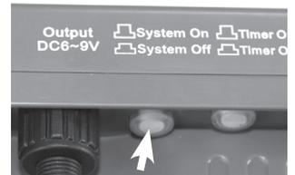
2. **Stellung 0 (OFF) (Aus):** Der Ausgang ist ausgeschaltet. Der Akku wird über das Solarmodul aufgeladen und die elektrische Energie wird gespeichert.
