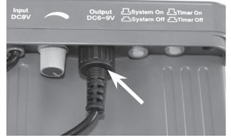
5. Rollen Sie das Kabel an der Akkustation ganz aus.
