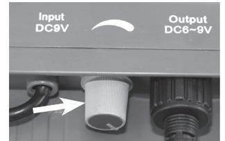
**Hinweis:** Die Stecker und Buchsen sind verpolungsgeschützt, es darf beim Einstecken keine Gewalt angewendet werden. Das Glas des Solarmoduls ist bruchempfindlich.
