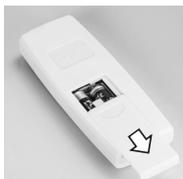
➔ Ein Batteriewechsel ist erforderlich, wenn die Reichweite zwischen IR-Fernbedienung und Solar-Leuchtkugel stark abnimmt oder die Solar-Leuchtkugel nicht mehr auf die IR-Fernbedienung reagiert.
