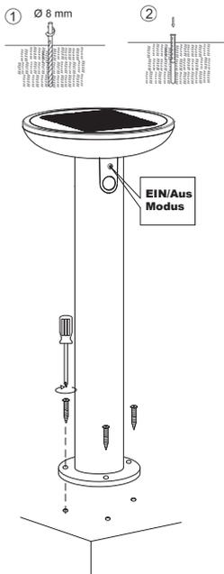
Die Solarleuchte muss über die drei Öffnungen am Standfuß auf einer glatten, ebenen Fläche festgeschraubt werden (siehe Bild 1 + 2). Eine Montage über einen Erdspieß macht auf Grund der Höhe der Leuchte keinen Sinn. Diese würde bei Wind umkippen und evtl. Schaden nehmen.
