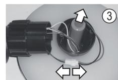
4 Insérez la nouvelle batterie et rebranchez le câble de connexion. Le connecteur est protégé contre l'inversion de polarité, mais ne forcez pas lors du branchement !
