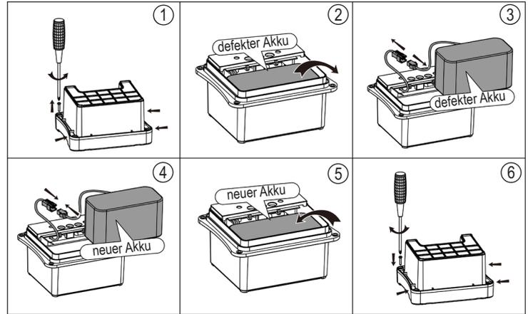
1. Bild 1: Schalten Sie den Akkuspeicher aus und stecken Sie alle angeschlossenen Kabel (Solarmodul, Solarpumpe, LED-Lichtring) ab. Lösen Sie die 4 Schrauben des Gehäuse und nehmen Sie den Deckel ab.
