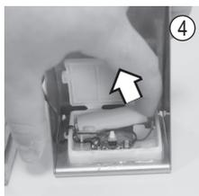
Verwenden Sie nur einen NiMH-Akku. Sie können anstelle des vorhandenen 600 mAh-NiMH-Akkus auch einen Akku mit größerer Kapazität einsetzen.
