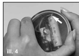
1. Tournez le module solaire dans le sens contraire des aiguilles d'une montre (illustration 4) et enlevez la partie supérieure (illustration 5).
