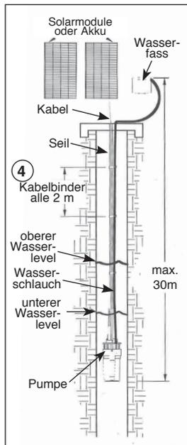
**Hinweis:** Beim Einlassen der Pumpe achten Sie bitte darauf das diese nicht am Grund aufliegt. Somit vermeiden Sie, dass die Pumpe im Betrieb zu viel Sand oder Schmutz ansaugt und der Filter frühzeitig verstopft.
