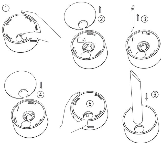
1. Bild 1+2: Drehen Sie die Klarsichtabdeckung an der Unterseite der Solarleuchte gegen den Uhrzeigersinn und nehmen Sie diese ab.
