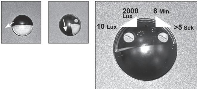
Zum Verstellen der Regler drehen Sie die Abdeckung einfach um 180° (siehe Bilder oben) von oben nach unten. Das Verstellen der Regler kann einfach mit Hilfe eines passenden Schraubendrehers vorgenommen werden. Bitte wenden Sie bei der Einstellung keine zu große Kraft an, da die Endstellungen durch Kunststoffteile eingeschränkt sind und diese bei zu hohem Kraftaufwand abbrechen können. Der Einstellbereich beträgt 270°.
