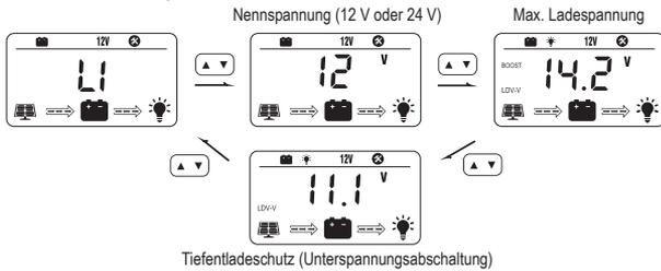
Der Einstellmodus wird verlassen, indem Sie die Taste (▲) etwa 3 Sekunden gedrückt halten (alternativ ca. 15 Sekunden keine Taste drücken). Die Anzeige hört auf zu blinken, der Akkutyp ist gespeichert.
