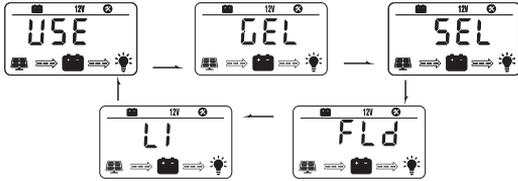
Nach Auswahl des Akkutyps „LI“ und der Bestätigung mit der Taste (▲) müssen Sie weitere Parameter des Lithium-Akkus eingeben:
