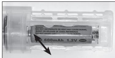
Sie können anstelle des vorhandenen 600 mAh-NiMH-Akkus auch einen Akku mit größerer Kapazität (z.B. 1100 mAh) einsetzen.
